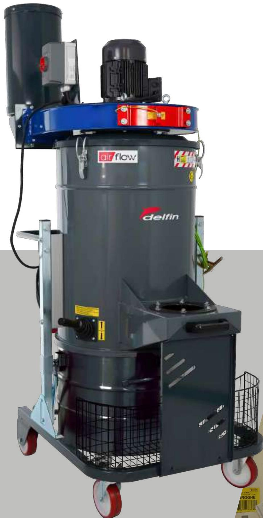
I depolveratori carrellati sono caratterizzati da una elevatissima portata d'aria; la funzione principale è quella di aspirare polveri in sospensione, per una miglior salubrità dell'aria all'interno dell'area di lavoro. Soluzione ideale anche per aspirazione localizzata direttamente a bordo di macchinari di processo.
