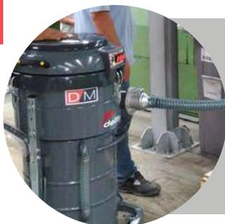
I modelli Tecnoil permettono di aspirare velocemente oli ed emulsioni dalle macchine utensili misti ai trucioli metallici residui delle lavorazioni, ne consentono la filtrazione e la reimmissione nel sistema, pronti per essere riutilizzati nei cicli di lavoro successivi.
