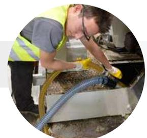
Pompa immersa per lo scarico dei liquidi simultaneo all'aspirazione Modelli "MPI"
