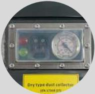
**Indicatore di ostruzione del filtro e vuotometro con spia luminosa**
